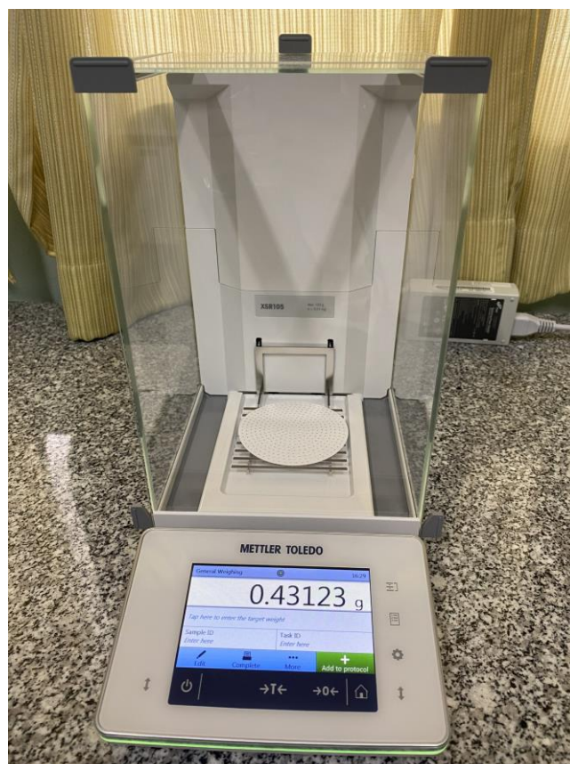
รูปที่ 8 เครื่องชั่ง 5 ตำแหน่ง ยี่ห้อ Mettler Toledo ประเทศสวิตเซอร์แลนด์ สำหรับชั่งกระดาษกรอง
