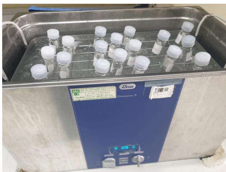
รูปที่ 9 เครื่องอัลตราโซนิค สำหรับสกัดสารพีเอเอชออกจากกระดาศกรอง
