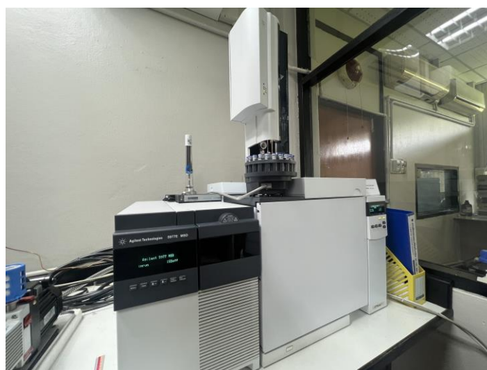
รูปที่ 11 เครื่องแก๊สโครมาโทกราฟี-แมสสเปกโตรเมตรี (GC-MS) ยี่ห้อ Agilent รุ่น 7820A-5977E
