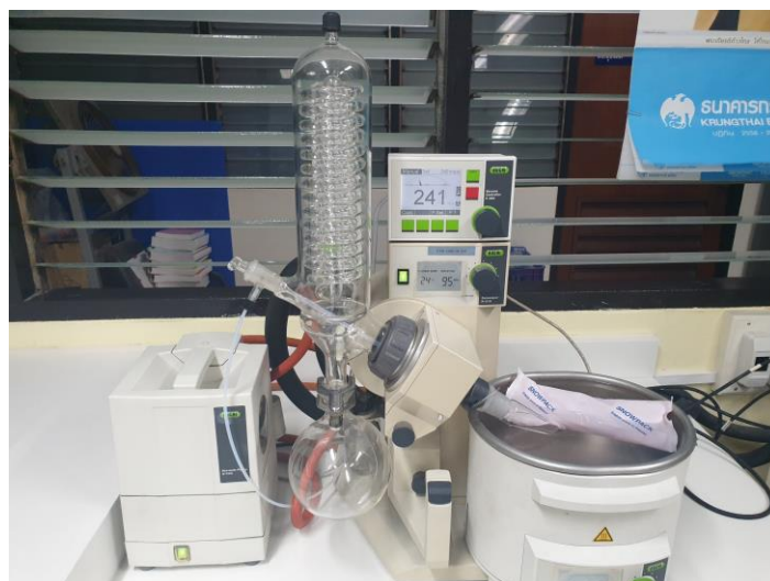
รูปที่ 10 เครื่องระเหยสุญญากาศ
