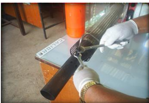
รูปที่ 4-5 ถอดท่อส่งน้ำยาพร้อมหัวพ่น และ การจับเวลา1นาทีที่ทำซ้ำ 3 ครั้ง
