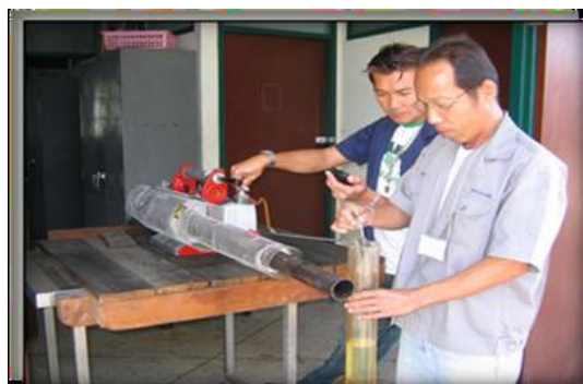
รูปที่ 4-5 ถอดท่อส่งน้ำยาพร้อมหัวพ่น และ การจับเวลา1นาทีที่ทำซ้ำ 3 ครั้ง
