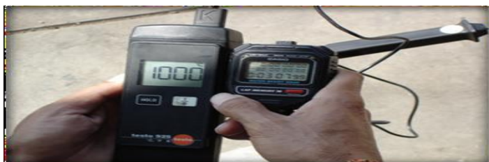
ภาพที่ 3 การวัดอุณหภูมิความร้อนบริเวณปลายท่อ
