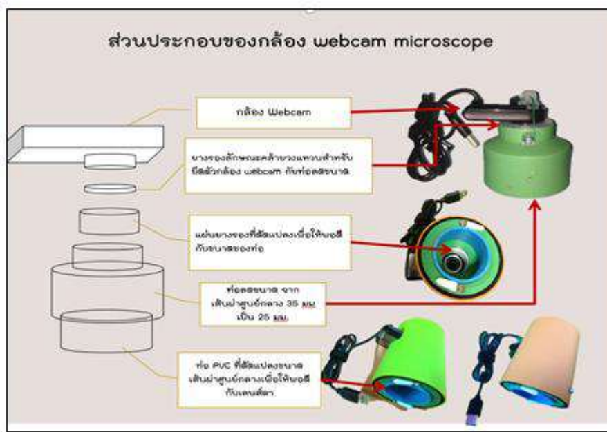
รูปที่ ๓.๑ แสดงส่วนประกอบของกล้องรูปแบบที่ ๑ ใช้เฉพาะในพื้นที่จังหวัดแม่ฮ่องสอน
