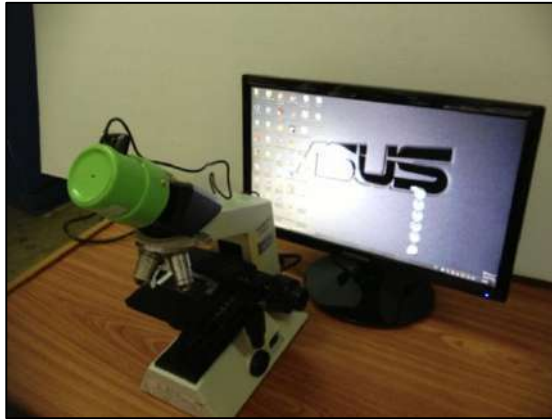
รูปที่ 2 แสดงวิธีการติดตั้ง อุปกรณ์ชุดกล้องประกอบเว็บแคมเพื่อถ่ายภาพจากกล้องจุลทรรศน์
