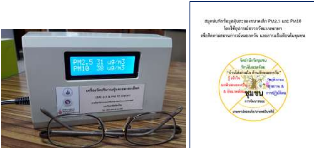
ภาพ ๒๕ แสดงอุปกรณ์ตรวจวัดแบบพกพา เพื่อติดตามสถานการณ์หมอกควัน และการแจ้งเตือนในชุมชน
