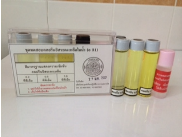
รูปที่ 2 ชุดตรวจคลอรีนอิสระคงเหลือในน้ำ
