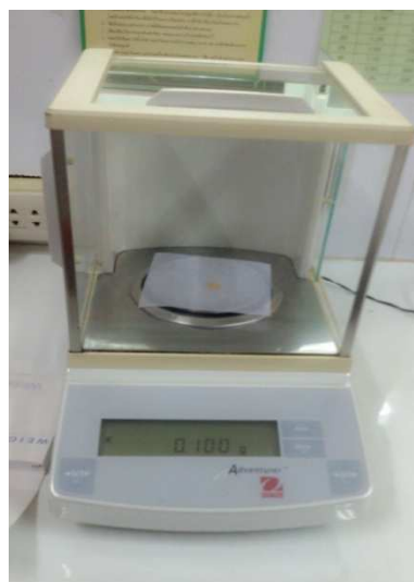
ภาพที่4สารเคมีเคลือบทรายกำจัดลูกน้ำ ที่น้ำหนัก 0.1 กรัม ทำการชั่งทุกตัวอย่างที่เก็บจากพื้นที่
