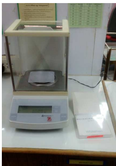
ภาพที่4สารเคมีเคลือบทรายกำจัดลูกน้ำ ที่น้ำหนัก 0.1 กรัม ทำการชั่งทุกตัวอย่างที่เก็บจากพื้นที่
