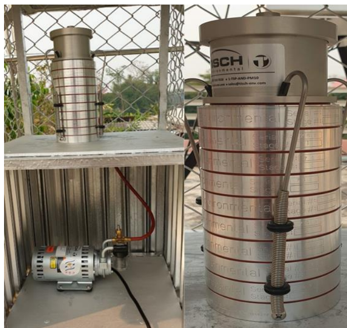
รูปที่ 6 เครื่องเก็บตัวอย่างอนุภาคฝุ่นแยกขนาด Eight-stage cascade impactor
