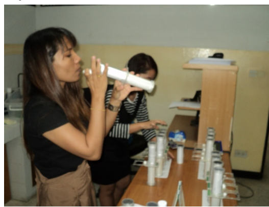
(d) เป่าเบา ๆ จากกระบอ holding ให้ยุงบิน ไปที่กระบอที่มีกระดาษสารเคมี
