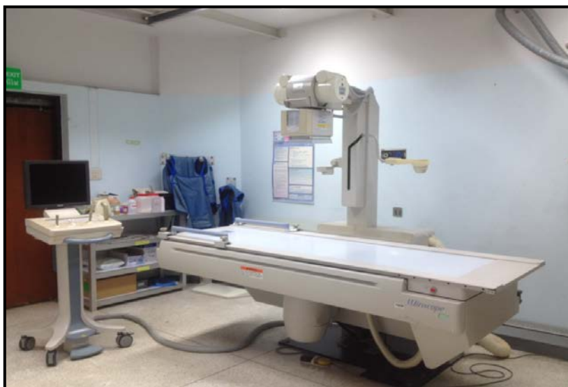
ภาพที่ 2 เครื่องเอกซเรย์ฟลูออโรสโคปีแบบดิจิทัลชนิดหลอดเอกซเรย์อยู่เหนือเตียง ภายใต้ระบบควบคุมปริมาณรังสีอัตโนมัติ (Automatic Exposure Control: AEC) ยี่ห้อ Toshiba รุ่น KXO-50XM Serial Number: K2D0912939
