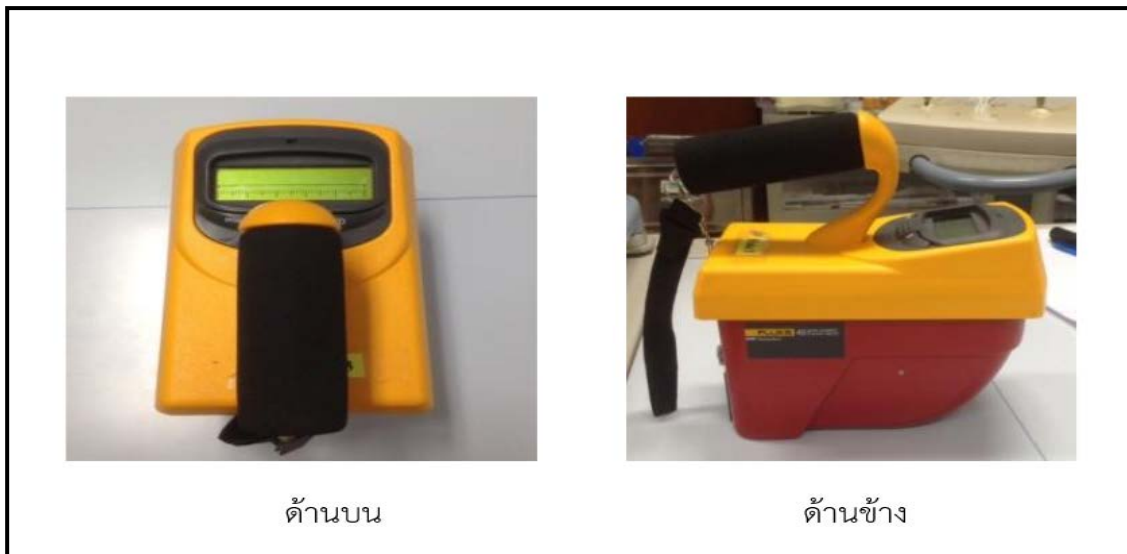
ภาพที่ 5 เครื่องสำรวจรังสี (Survey meter model) ยี่ห้อ Fluke รุ่น 451P-DE-SI-RYR S/N: 6608
