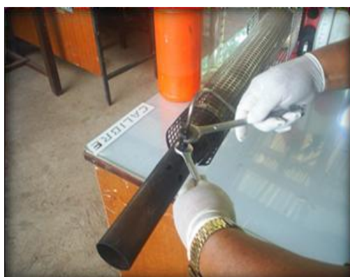
ภาพที่ 2.3-2.4 ถอดท่อส่งน้ำยาพร้อมหัวพ่น และ การจับเวลา 1 นาที ทำซ้ำ 3 ครั้ง
