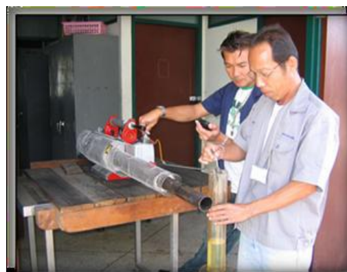
ภาพที่ 2.3-2.4 ถอดท่อส่งน้ำยาพร้อมหัวพ่น และ การจับเวลา 1 นาที ทำซ้ำ 3 ครั้ง
