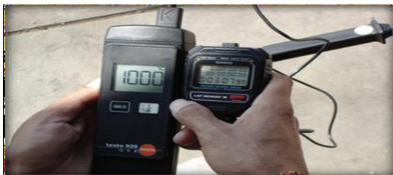
ภาพที่ 2.2 การวัดอุณหภูมิความร้อนบริเวณปลายท่อ
